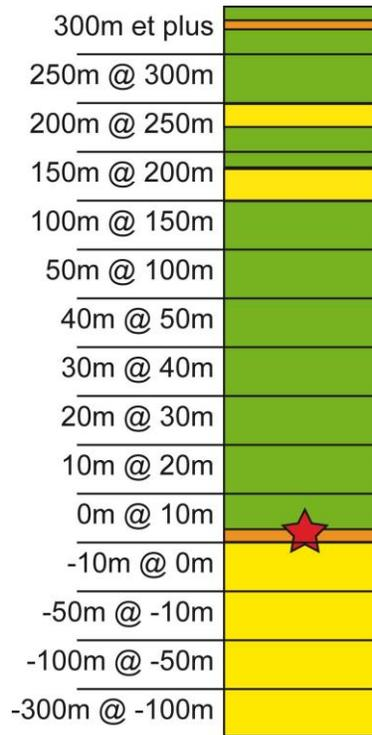
**Figure 4.** Schéma montrant les diverses tranches (zones tampons) pour lesquelles l'intensité de l'altération a été mesurée. Basé sur la stratigraphie du gisement de Bell-Allard Sud, l'étoile représente le gisement et indique le niveau 0. Les lithologies correspondent à celles identifiées à la Figure 3.
